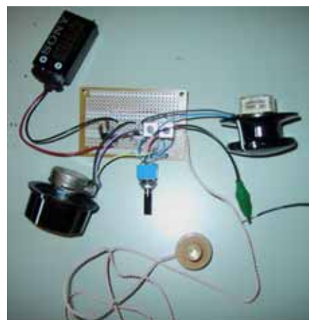
図10 FCZコイルを使用したバージョン(右:2バンド対応)
